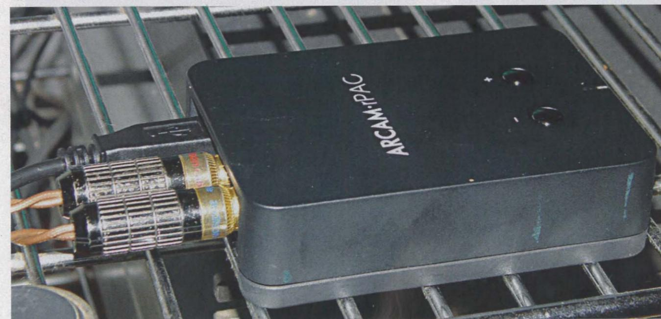
L'Arcam rPAC posto tra il PC e il preamplificatore nell'impianto del recensore.
